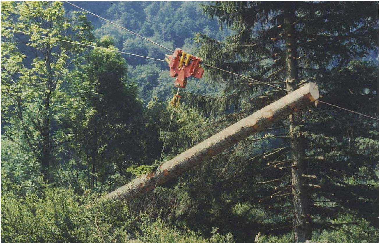
სურათი 7. საჰაერო-საბაგირო დანადგარის პრაქტიკული გამოყენება. გარემოს დაცვის თვალსაზრისით საჰაერო-საბაგირო სისტემები მიჩნეულია გარემოზე დაბალი ზემოქმედების სისტემებად.
