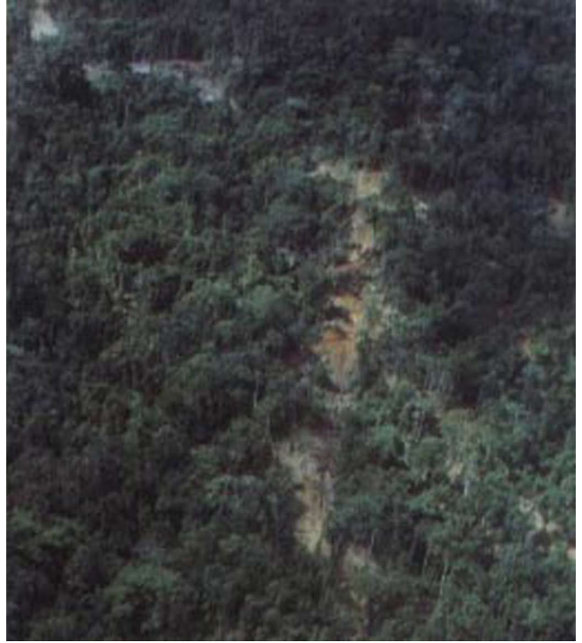
სურათი 8. მოცემულია ერთი და იგივე ტიპის ტყეში ერთნარი მოცულობის ხე-ტყის გამოტანის შედარება საჰაერო-საბაგირო დანადგარით (სურათზე მარცხნივ) და ჩვეულებრივ მიწაზე მორთრევით. მიწაზე მორთრევის შედეგად აშკარად შესამჩნევია ნიადაგის დაზიანება და კორომის ვარჯის შეკრულობის დარღვევა.
