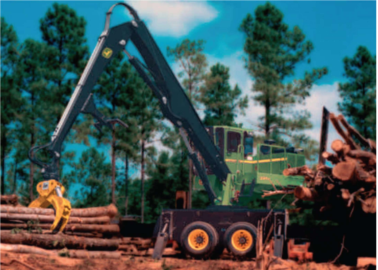
სურათი 9. knuckle-boom loader გამოყენება სასაწყობო ოპერაციებისთვის
